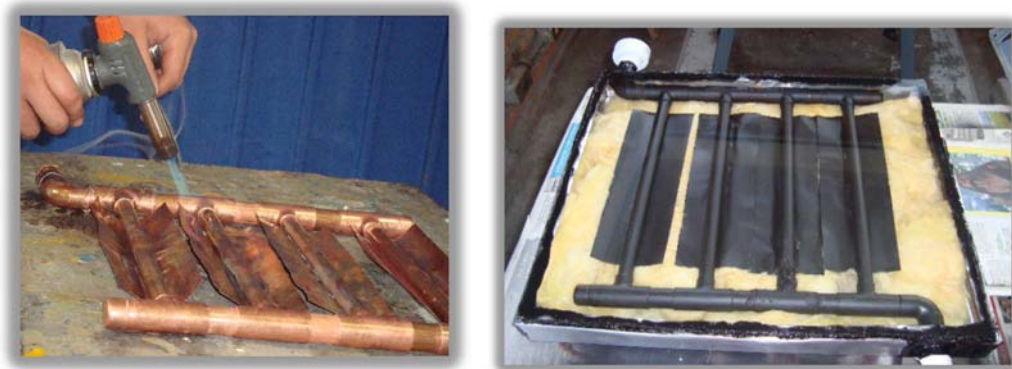
Figura.2.11 Calentador de Agua Solar (CAS).
