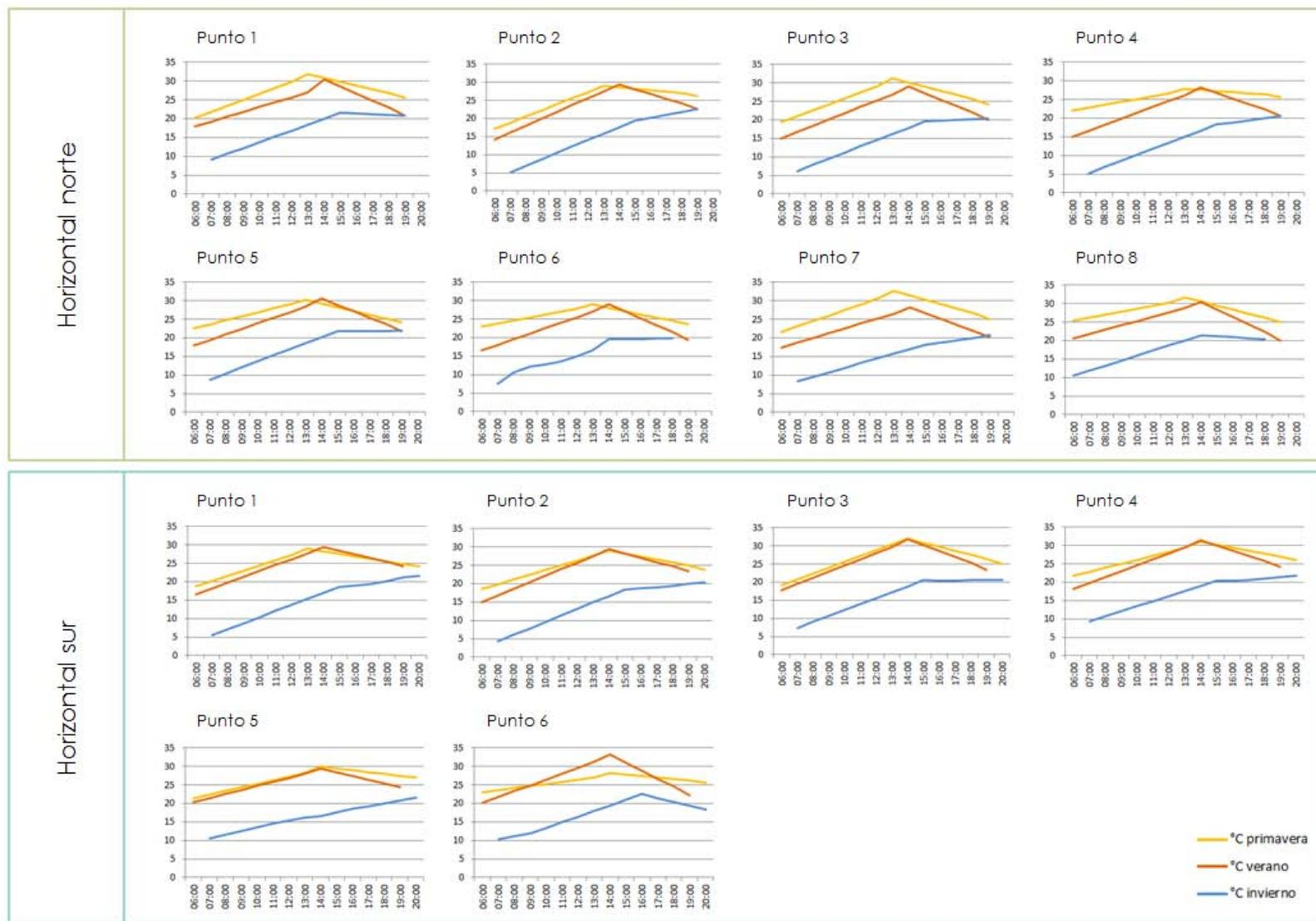
Figura 35. Variación diaria de temperatura en los puntos de muestreo (horizontal norte y horizontal sur)
