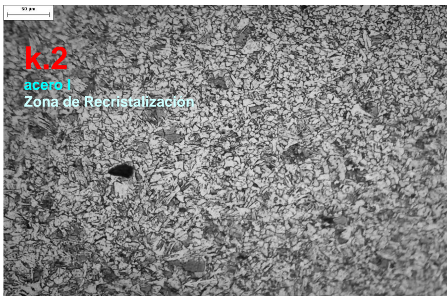
Figuras 42. Micrografía óptica de la zona de recristalización del acero I, a mayor aumento. Ataque con Nital 2 y Picral.
