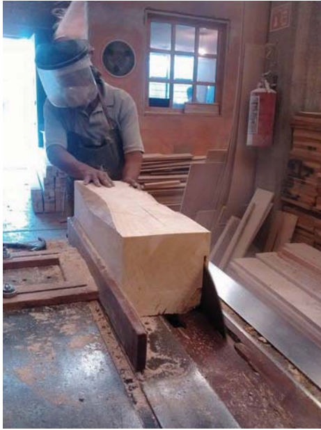
Ilustración 63: Corte y ahuecamiento del bloque de madera. Teponaztli Ángel de la Serna.
