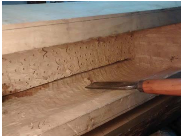
Ilustración 64: Corte de lengüetas y afinación del instrumento. Teponaztli Ángel de la Serna.
