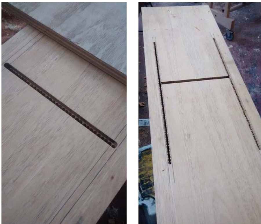
Ilustración 69: Cortes para las lengüetas. Log drum Ángel de la Serna.
