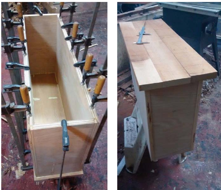
Ilustración 68: Ensamblado de la caja de resonancia y tapa para lengüetas. Log drum Ángel de la Serna.
