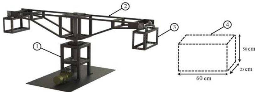
Fig. 10.1: Centrífuga del laboratorio de Termociencias: 1) sección fija, 2) sección rotatoria, 3) canastilla y 4) dimensiones características de la canastilla.
