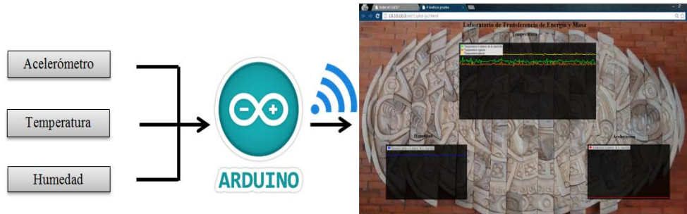
Fig. 13.9: Diagrama general del sistema inalámbrico para el monitoreo de las condiciones ambientales de la canastilla experimental, basado en la tecnología Arduino y páginas web.
