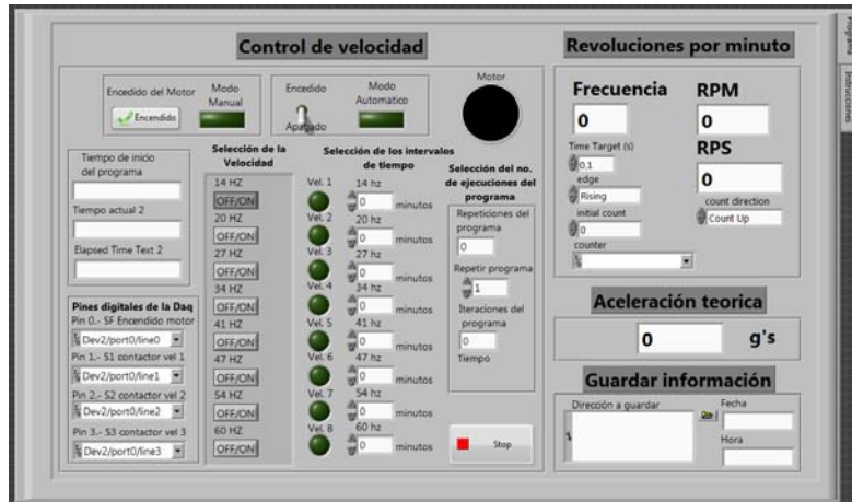
Figura 3 – Control de velocidad para la centrífuga, realizado en LabView
