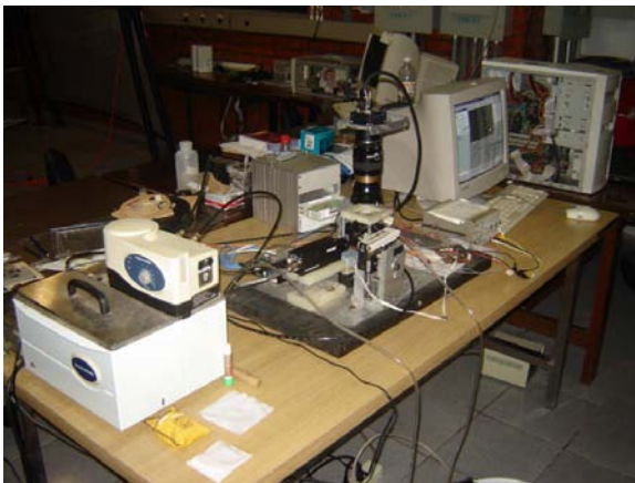
Fig. 3.1: Sistema de dos velocímetros por imágenes de partículas para analizar la convección natural en una cavidad cilíndrica, diseñado y construido en el Laboratorio de Transferencia de Energía y Masa del Departamento de Termociencias del Instituto de Energías Renovables.
