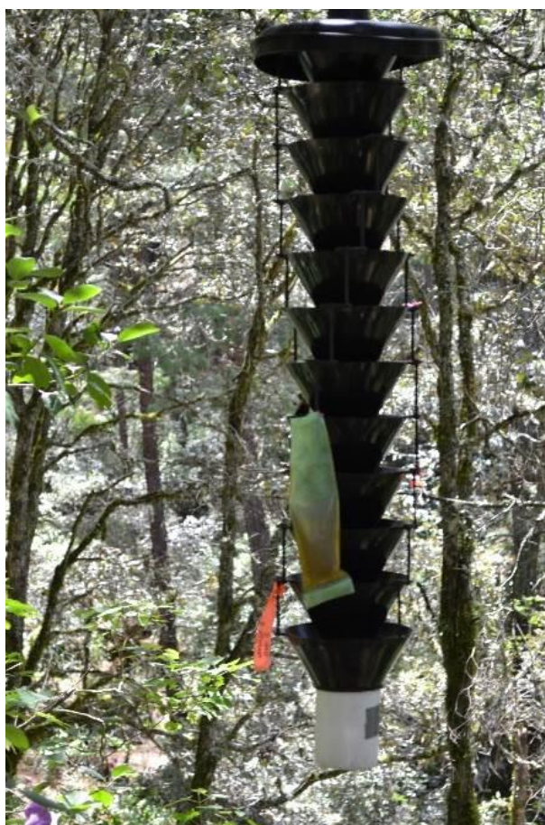
Figura 8. Trampa tipo Lindgren de 12 conos (multiembudo).
