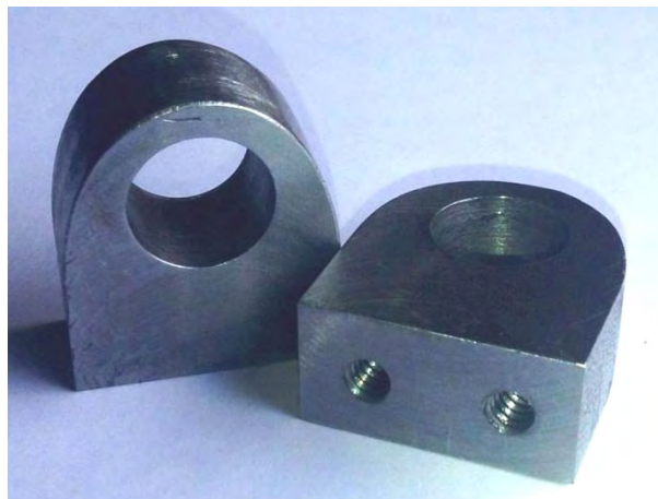
Figura. 3.61 Oreja, pieza que se ensambla a la placa y que le permite realizar el movimiento angular.
