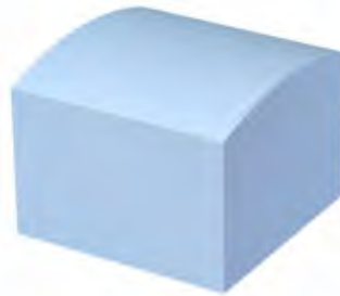
Figura 3.17 Seguidor, pieza que se deslizará sobre la cuña y proporcionará el ángulo a la placa.
