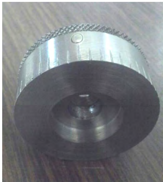
Figura 3.79 Barril, proporciona un avance en milésima de pulgada al sistema de profundidad de corte.
