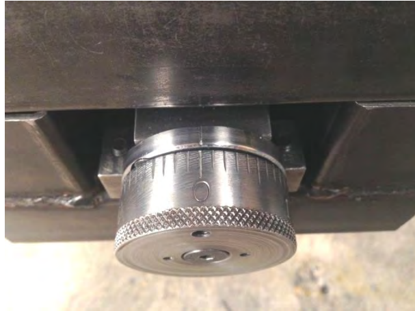
Figura 3.86 Barril del sistema de profundidad de corte.
