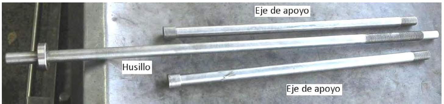
Figura 3.76 Ejes guía y husillo principal. El mecanismo de profundidad de corte se desliza sobre los ejes guía. El husillo junto con la base del conjunto motor-piedra forma el mecanismo.
