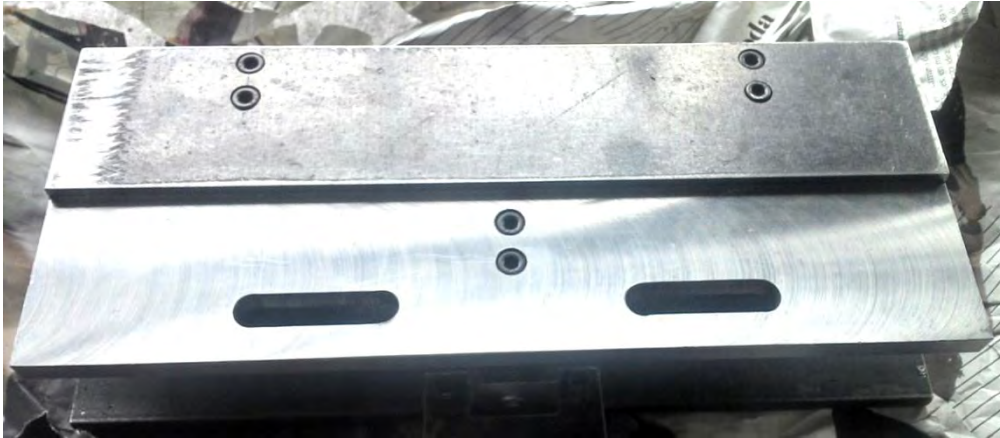
Figura 3.68 Placa de sujeción. En esta pieza se montan las cuchillas y se ensamblan algunas piezas del mecanismo.
