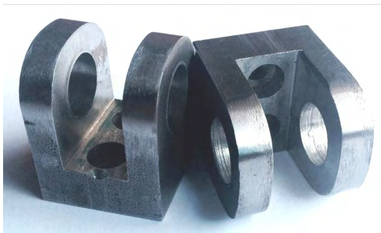
Figura 3.62 Macho-oreja, pieza que se ensambla a la placa base y contendrá a la "oreja".
