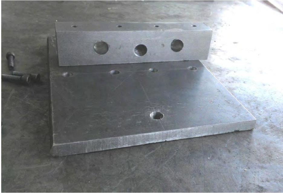
Figura 3.75 Base del conjunto motor-piedra. En esta se sujeta el conjunto motor-piedra.
