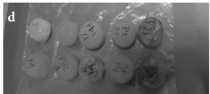
Siembra de partículas sub micrométricas de minerales de fósforo en morteros hidráulicos de cemento para mejorar su desempeño mecánico.
