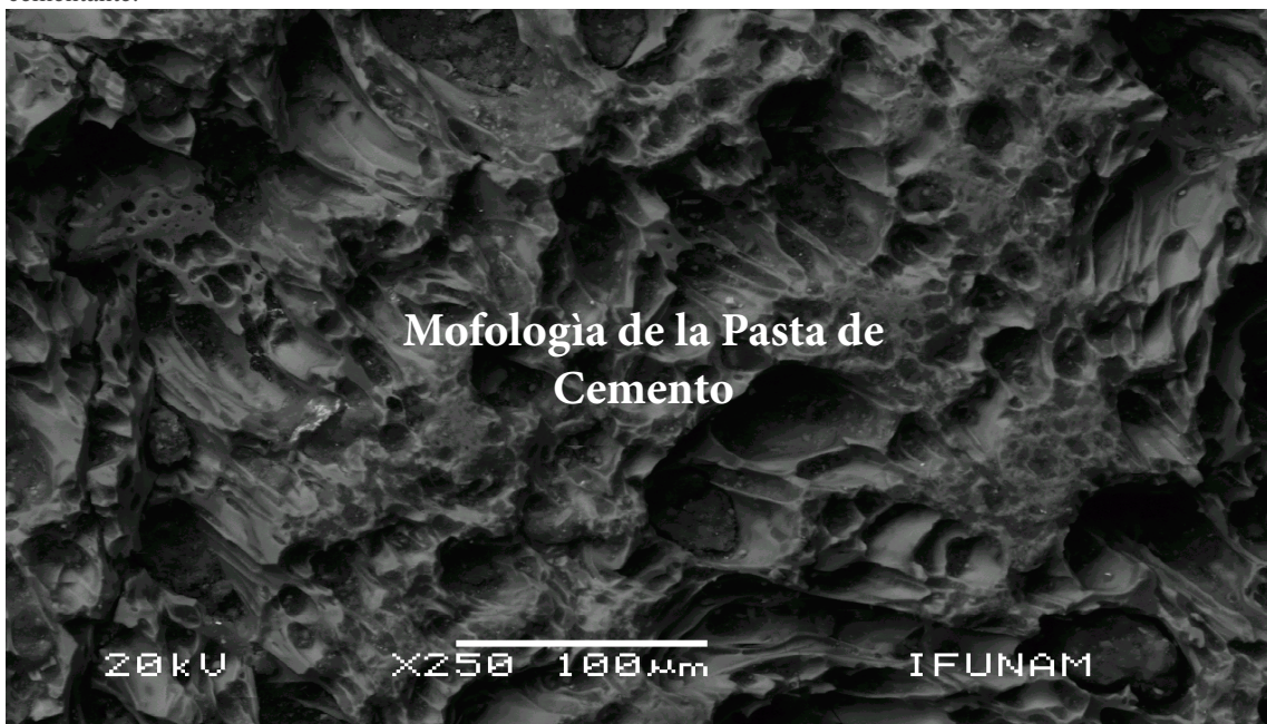
▲ Figura No. 36-B.- Imágen de Microscopia Electrónica de Barrido a 250 ampliaciones mediante rayos dispersados a bajo vacio en la Zona 1-A tomada en la muestra de Mortero sin aditivo a los 28 días de endurecimiento, donde se observa la morfología de la pasta de cemento.
