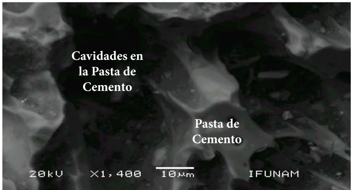
▲ Figura No. 36-C.- Imágen de Microscopia Electrónica de Barrido a 1400 ampliificaciones mediante rayos dispersados a bajo vacio en la Zona 1-A tomadas en la muestra de Mortero sin aditivo a los 28 días de endurecimiento, donde se observa la porosidad en la morfología de la pasta de cemento.
