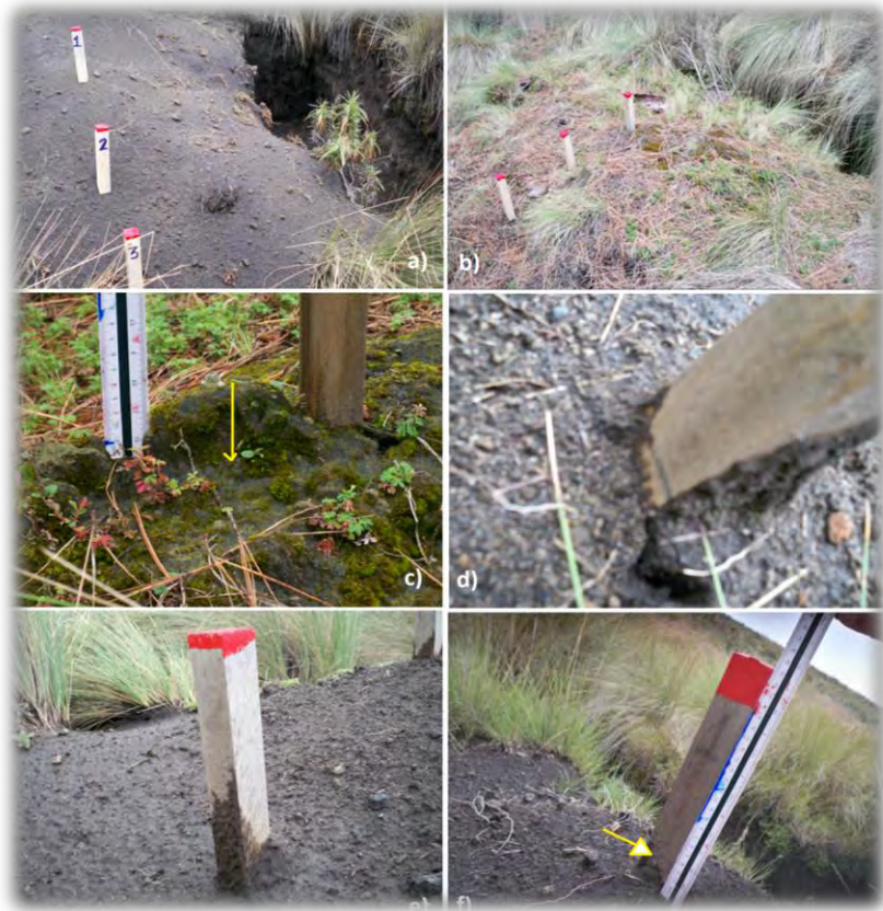
Figura 30. a) Estacas colocadas en el pastizal y b) en el bosque. Evidencias de movimiento de partículas a partir de c) formación de pedestales, d) y f) sedimentos debajo de la marca inicial de la estaca, e) Acumulación de sedimentos impregnados en las estacas.
