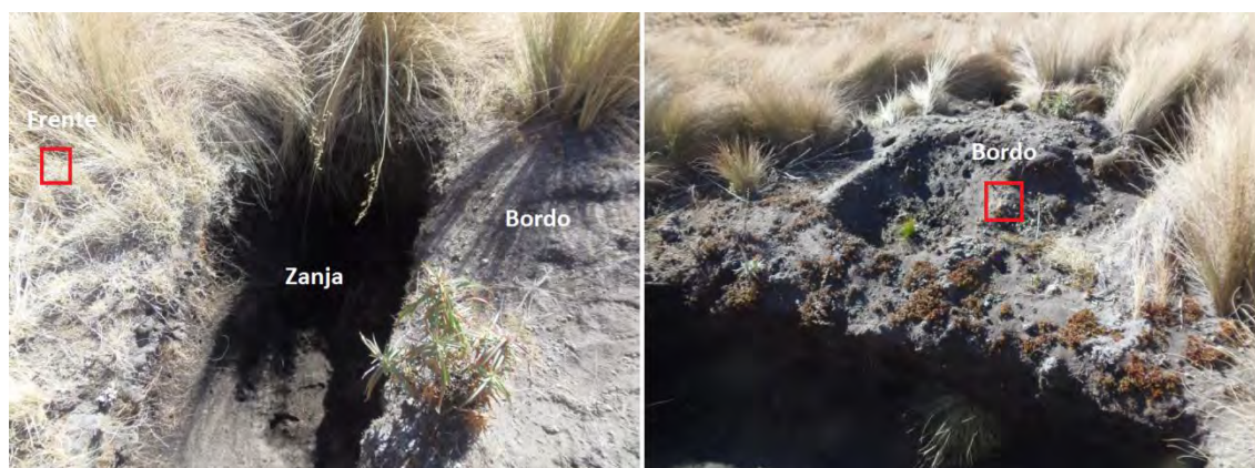
Figura 13. Puntos seleccionados para la prueba de estabilidad de agregados para las muestras en a) El frente de la zanja y b) El bordo de la zanja. Marzo, 2015.
