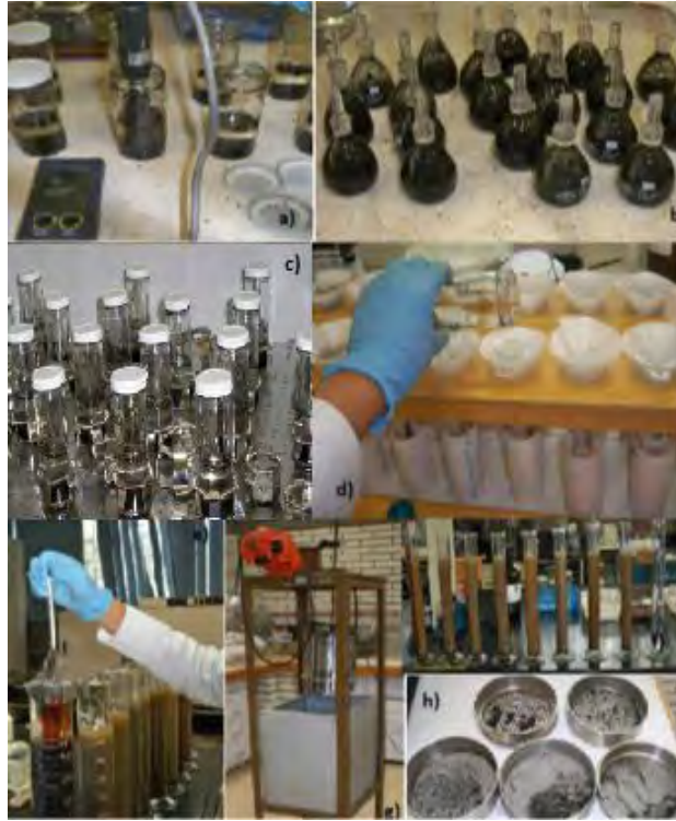
Figura 15. Análisis de laboratorio: a) Lectura de pH, b) Densidad real, c) y d) Filtrado de muestras para el método de conductividad eléctrica, e) y f) Determinación de textura con el método de Bouyoucos, g) Equipo empleado en el método de Yoder modificado y h) Tamices para diferentes fracciones en la determinación de estabilidad de agregados.
