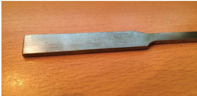
FIGURA 8. PROBETA DE ACERO ESTRUCTURAL PARA PRUEBA DE TRACCIÓN, LA CUAL NO PASÓ EL CONTROL DE CALIDAD, POR LOS CORTES INEXACTOS AL MOMENTO DE SU CREACIÓN. “ELABORACIÓN PROPIA.
