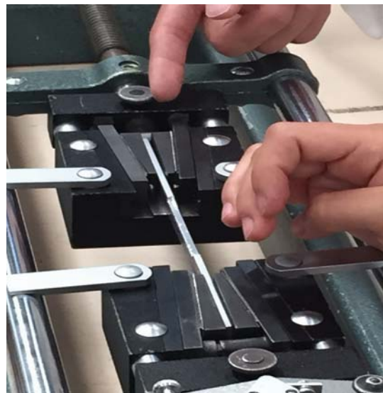
FIGURA 19. MÁQUINA PARA ENSAYE DE TRACCIÓN. “ELABORACIÓN PROPIA”.
