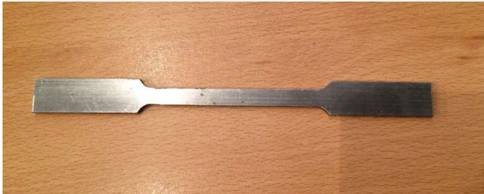
FIGURA 23. PROBETA DE ACERO ESTRUCTURAL, PARA PRUEBA DE TRACCIÓN. "ELABORACIÓN PROPIA".
