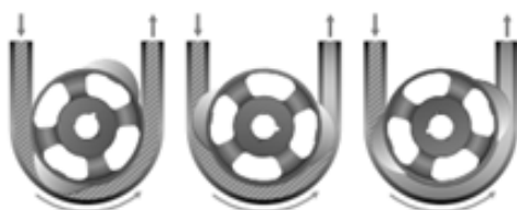
Figura 5 Principio de trabajo de una bomba peristáltica [22]
