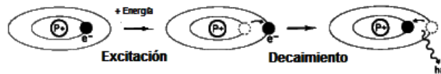
Figura 1 Modelo atómico de Bohr. Al absorber energía el átomo, un electrón se excita a un orbital de un nivel de mayor energía. El átomo puede decaer a un estado de menor energía produciendo un fotón, h\nu . (Modificado de la referencia [16])
