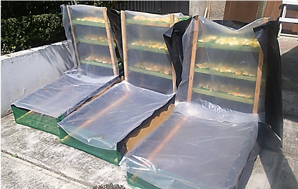
Figura 4.6 Deshidratadores solares con cáscaras de cítricos
