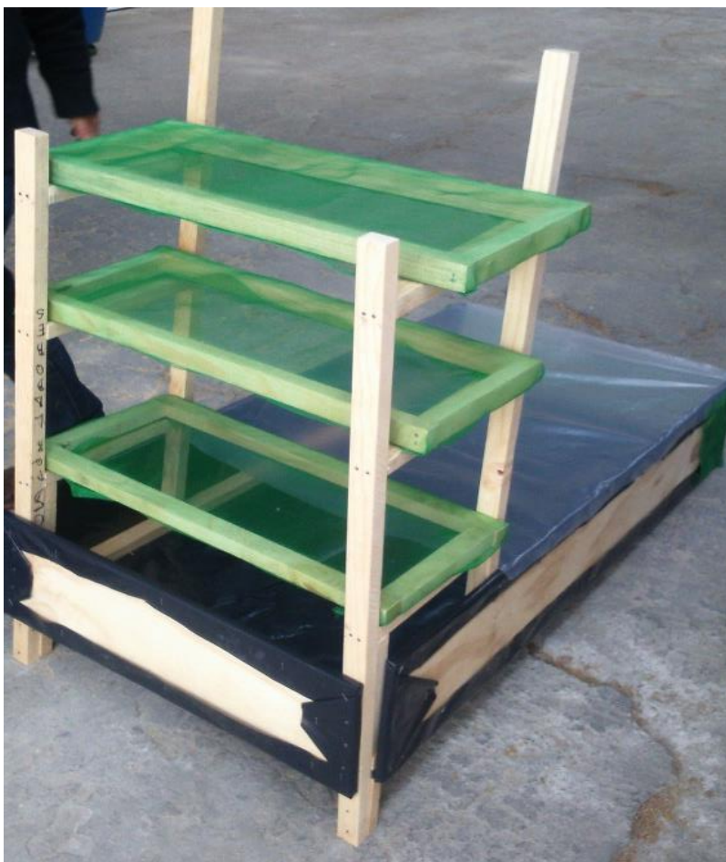
Figura 4.3 Deshidratador solar en proceso de fabricación con bastidores
