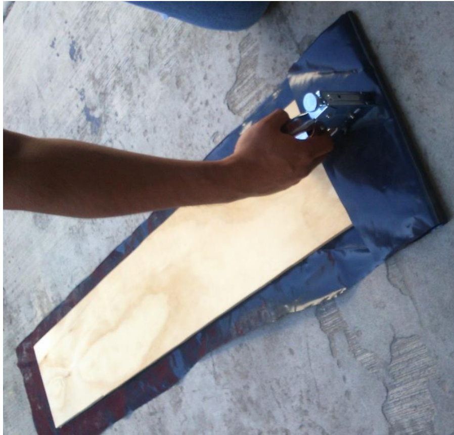
Figura 4.2 Forrado de las tablas de madera con PEHD negro
