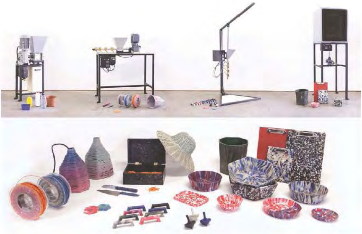
Ilustración 39. Máquinas de producción de plástico reciclado. Imágenes recuperadas de http://www.preciousplastic.com/
