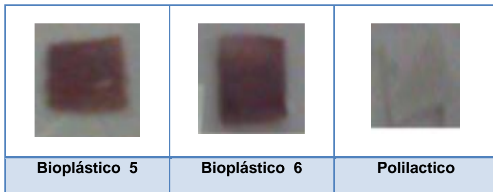
Figura 14. Prueba Yodo-yoduro para determinar la presencia de almidón en los bioplásticos
