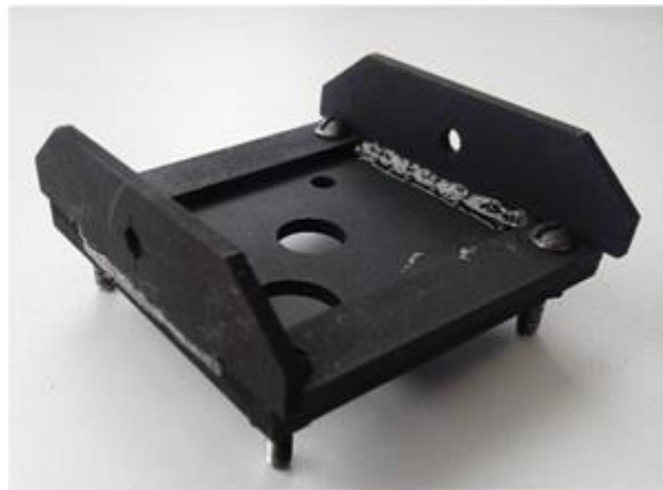
Figura 46. Base para sujetar los sensores.
