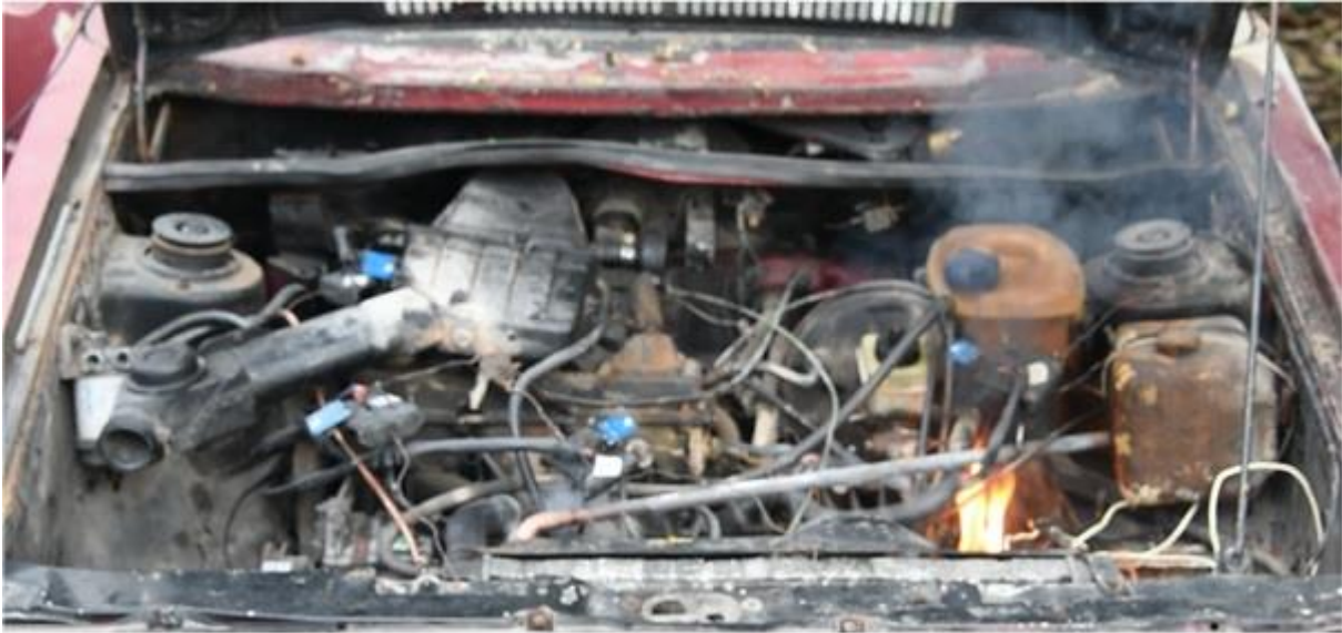
Figura 70. Momento en el cual se acciona el sistema de contención al ser detectado el fuego.
