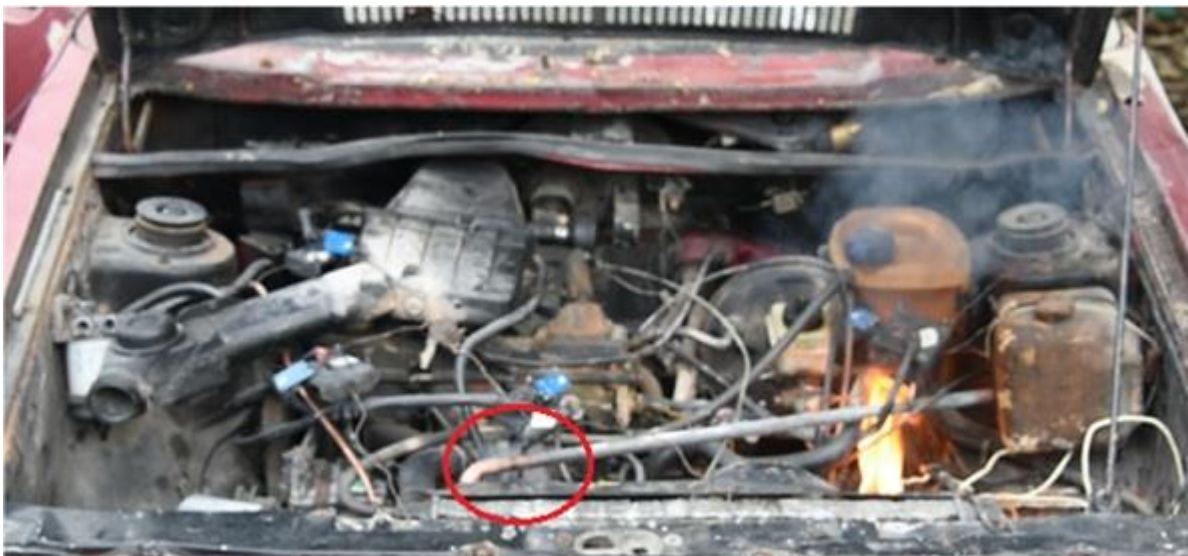
Figura 69. Inicio del incendio en cada fuente generadora.
