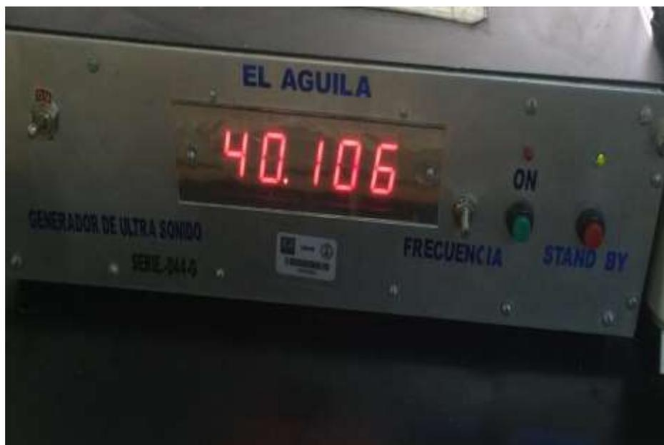
**Figura 4.2.** Control de frecuencia para el transductor de ultrasonido.
