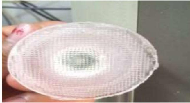
**Figura 5.5.** Gel formado correspondiente al dato de la figura 5.2.b. En una geometría de plato rugoso.
