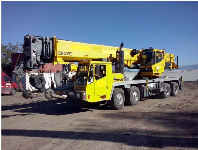
*Figura 4.8 Grúa Hidráulica de 60 toneladas.*
