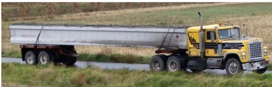
*Figura 4.2 Tractocamión y dolly de 2 ejes.*
