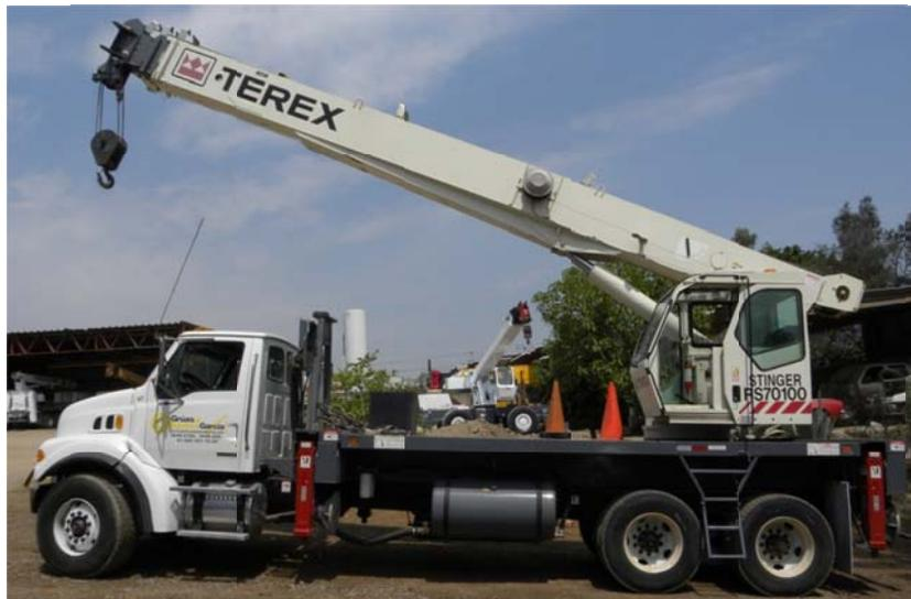
*Figura 4.6 Grúa Hidráulica de 35 toneladas.*
