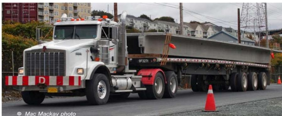
*Figura 4.3 Tractocamión y dolly de 3 ejes.*
