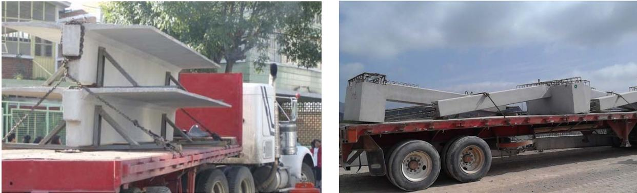
*Figura 1.33 Diferentes maneras de transportar los elementos prefabricados.*
