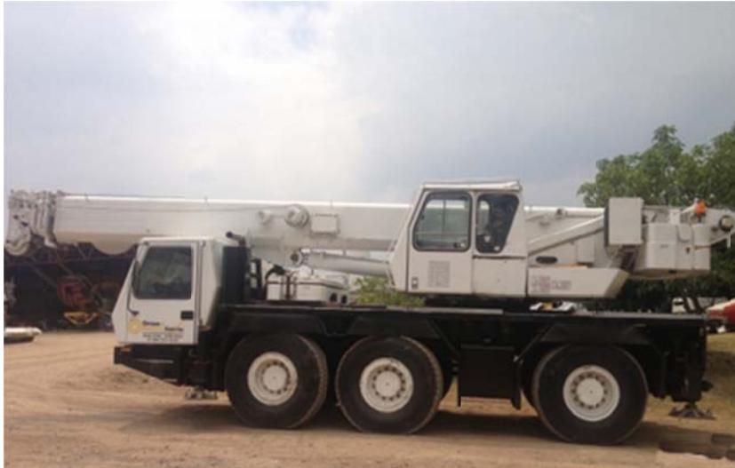
*Figura 4.7 Grúa Hidráulica de 50 toneladas.*
