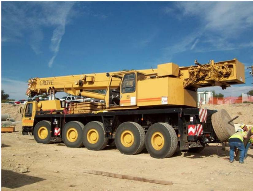
*Figura 4.9 Grúa Hidráulica de 100 toneladas.*
