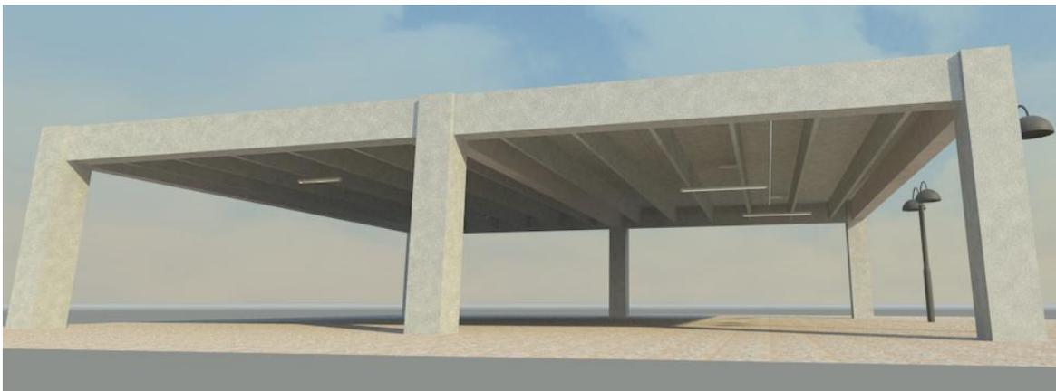
*Figura 1.30 Estructuración típica de un edificio prefabricado.*
