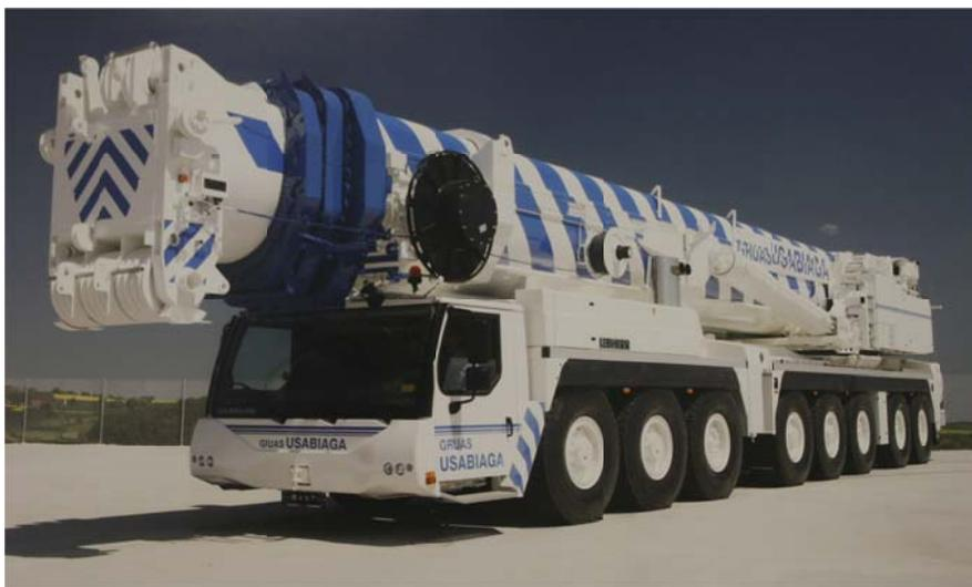
*Figura 4.10 Grúa Hidráulica de 500 toneladas.*
