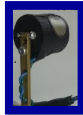
Figura 20.1. Brazo para la aplicación del golpe (estimulo) sobre el mentón
