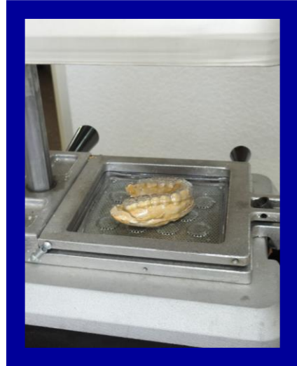
Fig. 13.3 Conformación de acetato rígido
