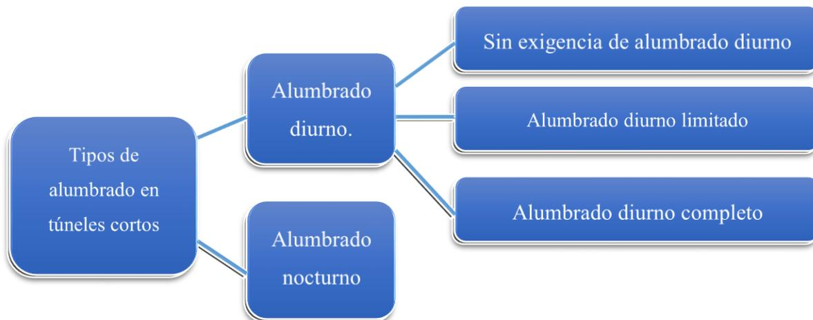
Diagrama 11. Tipos de alumbrado en túneles cortos.
