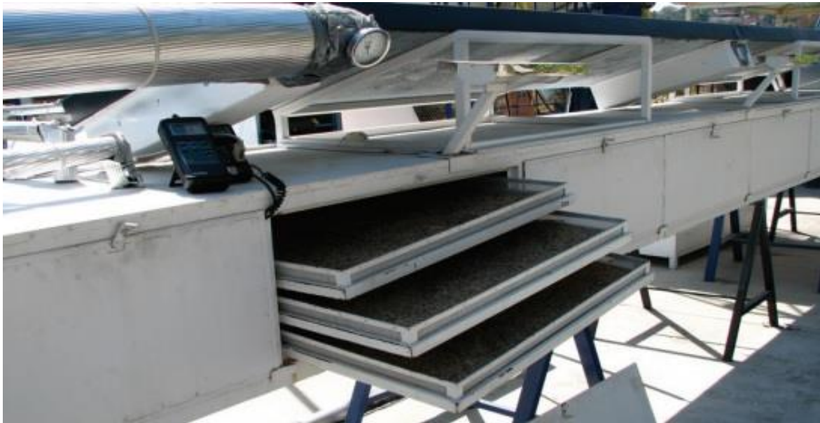
Figura 2. Prototipo de secador que opera con energía térmica solar y fotovoltaica (Centro de Investigaciones en Energía).
