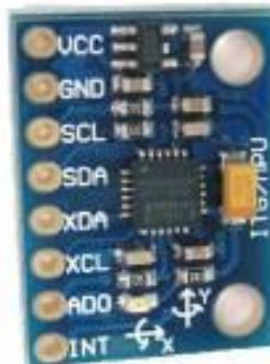
Figura 48: Diagrama de los pines del MPU6050
