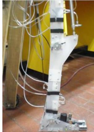
Figura 21: Prótesis de pierna neumática [17].
