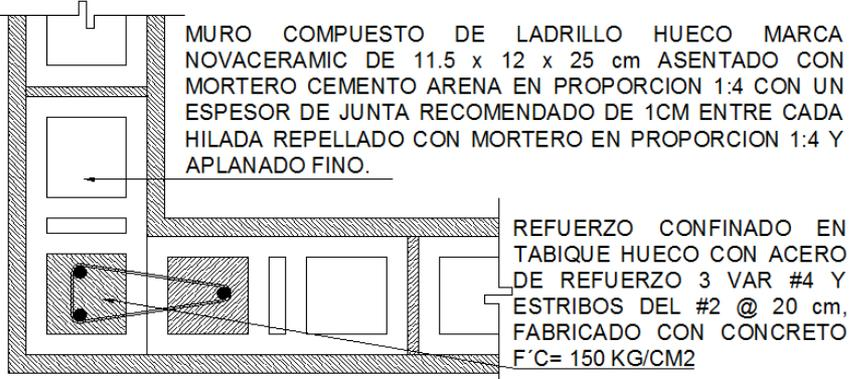
5 DT-ALB- 05 DETALLE DE ESQUINA DE MUROS DE LADRILLO
