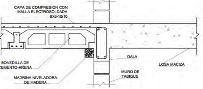
BOVEDILLA DE CEMENTO-ARENA      DALA      MURO DE TABIQUE      LOSA MACIZA
