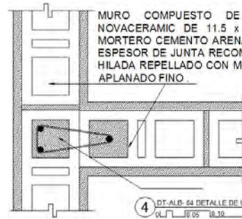
MURO COMPUESTO DE LADRILLO HUECO MARCA NOVACERAMIC DE 11.5 x 12 x 25 cm ASENTADO CON MORTERO CEMENTO ARENA EN PROPORCION 1:4 CON UN ESPESOR DE JUNTA RECOMENDADO DE 1CM ENTRE CADA HILADA REPELLADO CON MORTERO EN PROPORCION 1:4 Y APLANADO FINO.
