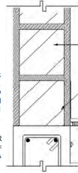
MURO COMPUESTO DE LADRILLO HUECO MARCA NOVACERAMIC DE 11.5 x 12 x 25 cm ASENTADO CON MORTERO CEMENTO ARENA EN PROPORCION 1:4 CON UN ESPESOR DE JUNTA RECOMENDADO DE 1CM ENTRE CADA HILADA REPELLADO CON MORTERO EN PROPORCION 1:4 Y APLANADO FINO.
