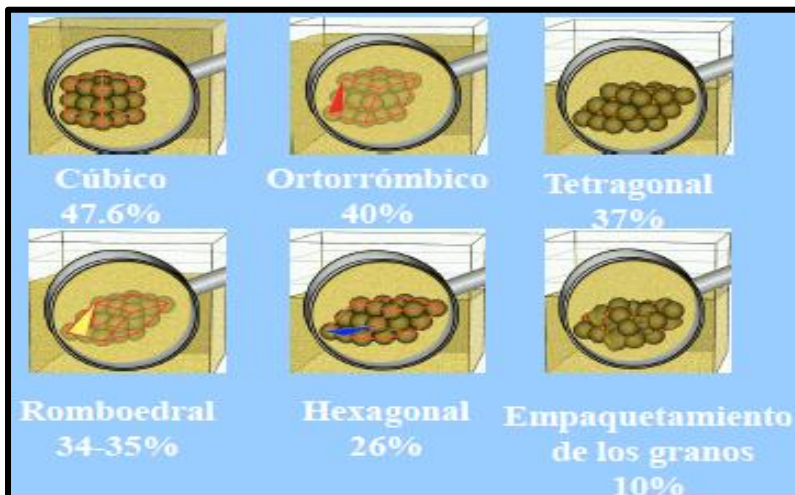
FIG. 4.3 TIPOS DE EMPAQUETAMIENTOS TEÓRICOS DE LA POROSIDAD
