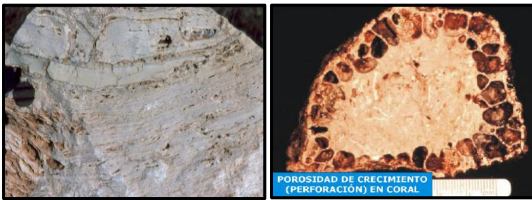
FIG. 4.11 POROSIDAD FENESTRAL (IZQUIERDA) FIG. 4.12 POROSIDAD POR ESTRUCTURAS DE CRECIMIENTO (DERECHA)
