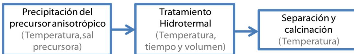
**Figura 2.1** Proceso de síntesis de materiales 1D de CeO<sub>2</sub> y M-CeO<sub>2</sub> por método hidrotermal y parámetros de importancia en cada paso.
