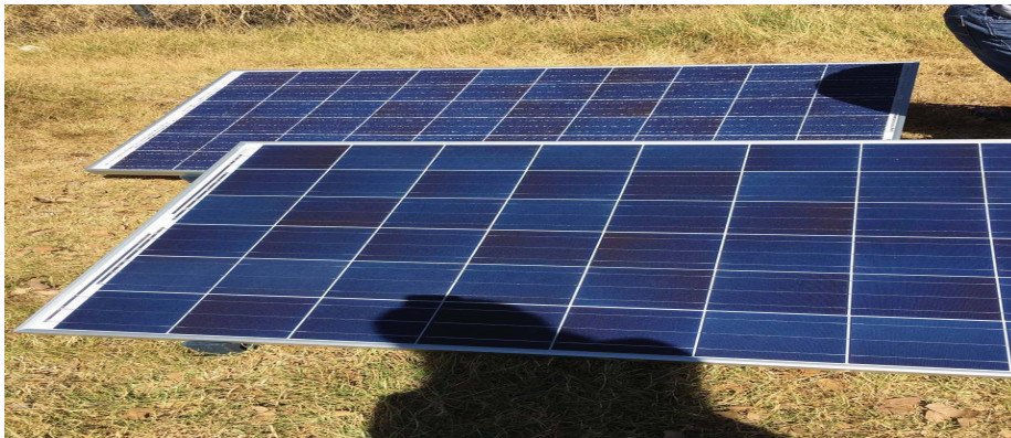
Fig. 37 Paneles fotovoltaicos que serán utilizados para pruebas de envejecimiento
