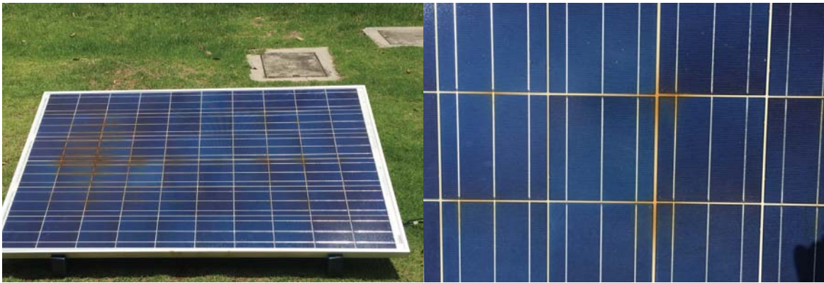
Fig. 44 Panel 2 envejecido, parte frontal
