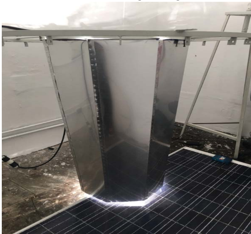
Fig. 32 Estructura cámara de envejecimiento
