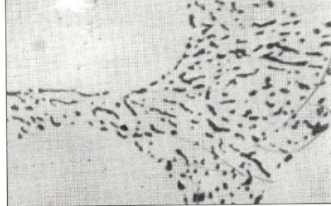
Nivel 5: Estructura bien modificada. El silicio está presente en forma de partículas fibrosas redondeadas.
