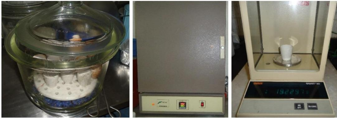
Figura 5. 1. Obtención del peso constante de los crisoles.
