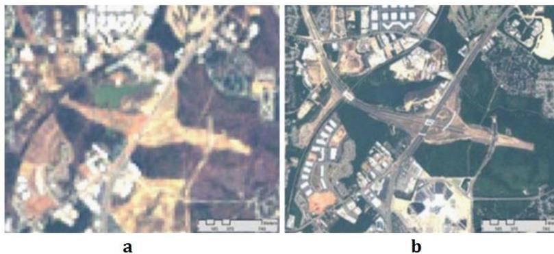
Figura 3. 2 Comparación entre imágenes, a) Landsat 7 (30 m) y b) Quickbird (2.62 m), de la misma área donde se demuestra la gran diferencia en la resolución espacial entre los dos sensores (modificado de Khorram *et al.*, 2012).
