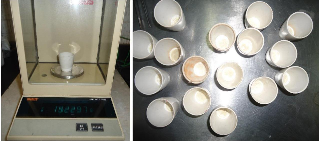
Figura 5. 3. Peso final y crisoles con sedimentos.
