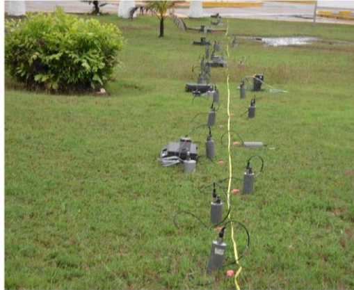
Figura 2.- Muestra tendido de dispersión sísmica a lo largo de la línea 3.
