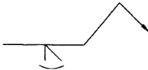
FIGURA 5.29 Soldadura de penetración parcial con bisel y acabado convexo mediante soldeo (según las recomendaciones del AWS)
