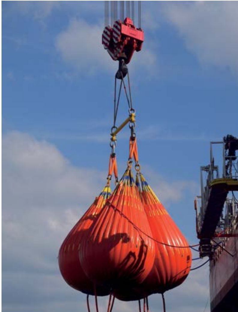
Figura 3.1 Fotografía de una prueba de carga
