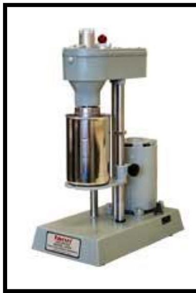
Figura 2.2 Viscosímetro Fann 35-VG
