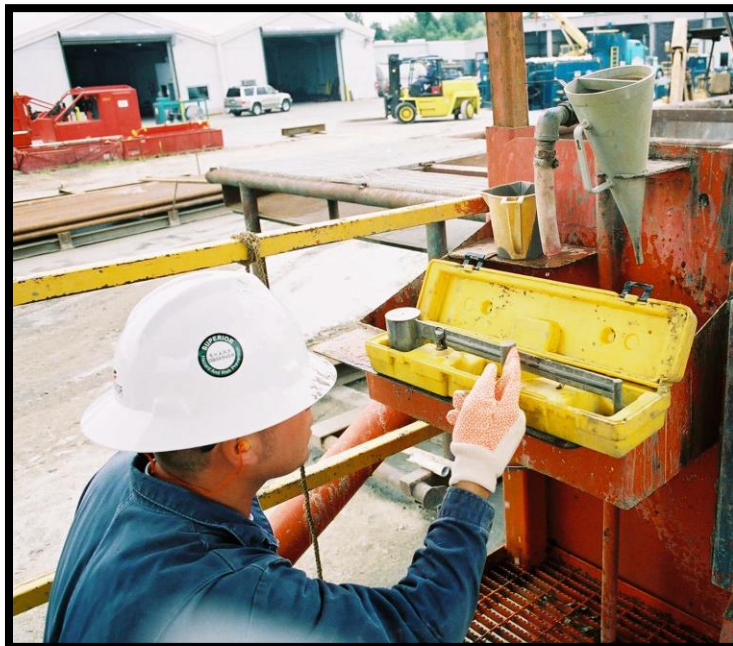
Figura 4.3 La densidad del lodo debe ser registrada y verificada permanentemente
