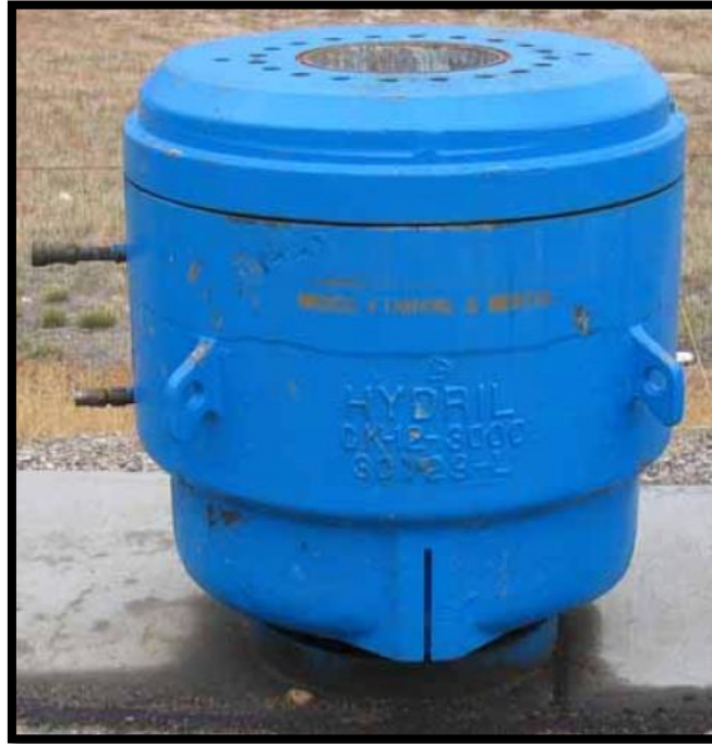
Figura 3.3 Preventor Hydril modelo GK
