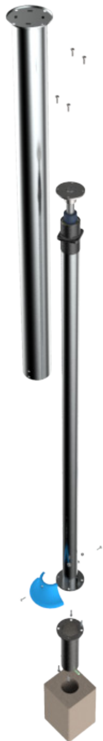
>>> 2. Explosivo de Columna & Camisa, Se puede ver la cabeza del mecanismo expuesto.
