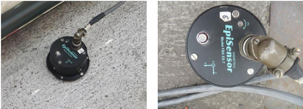
Figura 4.1 Acelerómetro modelo FBA ES-T, Kinometrics
