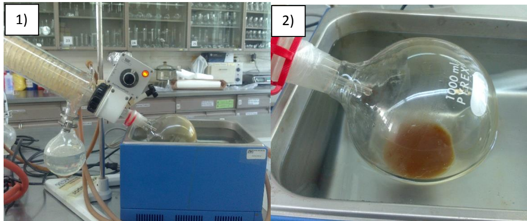
Figura 5. Evaporación del etanol de la mezcla en rotovapor.
