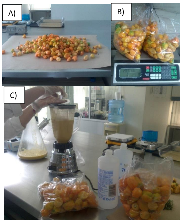
Figura 2. A) Selección del chile habanero. B) Pesaje del chile habanero. C) Licuado del chile habanero con alcohol etílico para la elaboración de la oleorresina de Capsicum .
