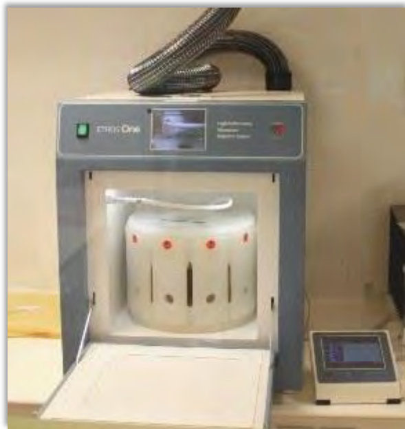
Figura 8 Horno de microondas Ethos One
