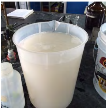
Figura 2.3 Precipitación de la proteína con hexametáfosfato de sodio ( \text{NaPO}_3 ) 6 al 10%.
