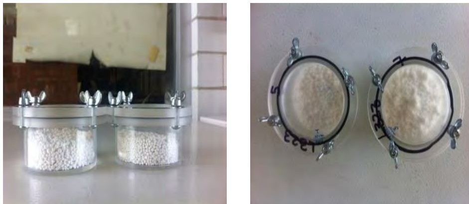
Figura 2.9 Películas colocadas en las celdas con el desecante \text{CaCl}_2 anhidro.
