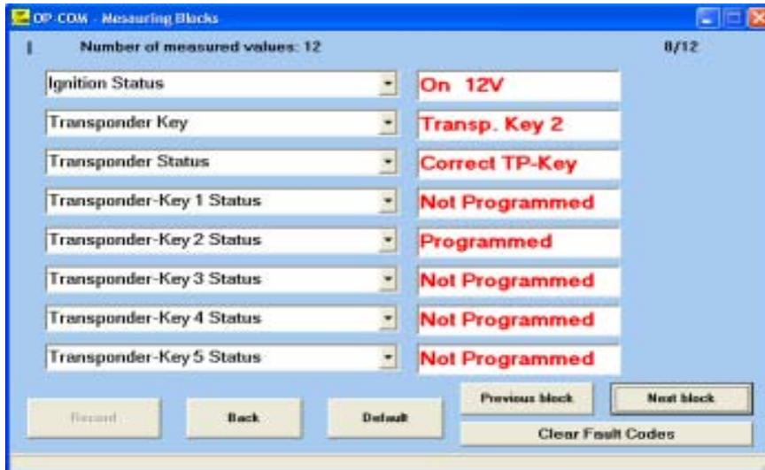
**Figura V.81 Programación de Inmovilizador Paso 3 OPEL COM**
