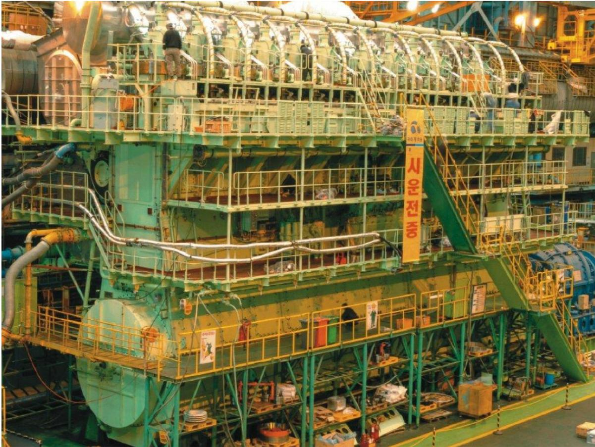
**Figura (I.3.1) Motor de 108.920 CV. Dimensiones: 26.7m x 13.2m Peso: 2300 Tons Consumo : 6.275 ltrs por Hora**
