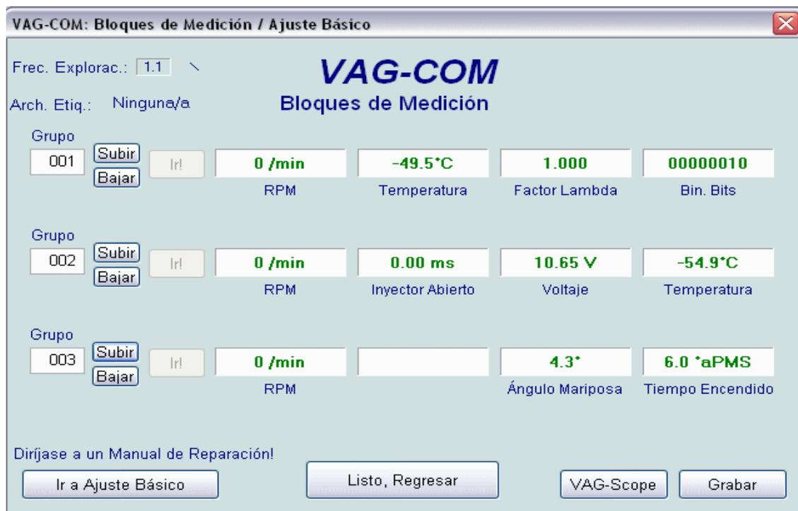
**Figura V.51 Bloque de mediciones de ajuste.**
