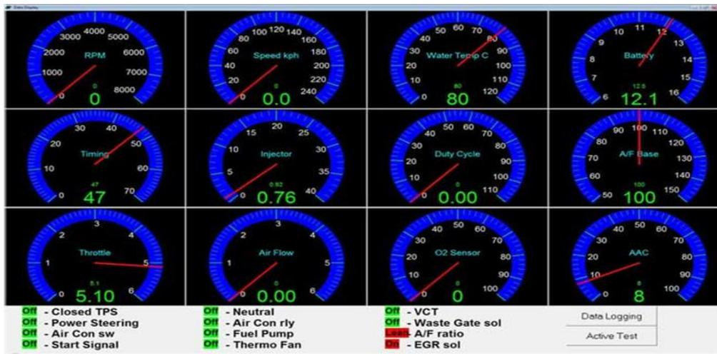
**Figura V.61 Ventana de monitoreo de sensores.**
