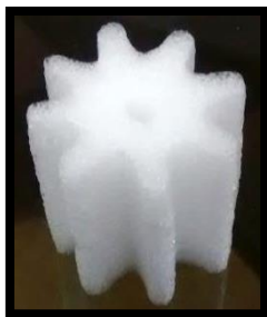
Fig. 2.34 Espuma utilizada para atenuador de impacto.
