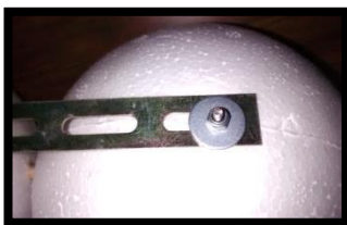
Fig. 2.11 Elementos de sujeción para sistema de amortiguamiento.
