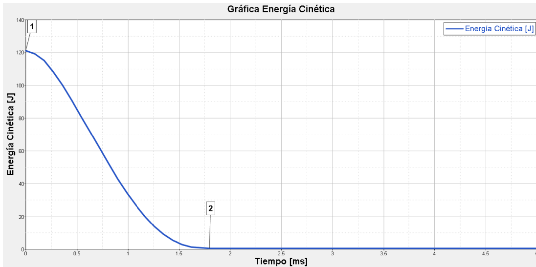
Gráfica 3.5 Energía cinética vs. Tiempo. Punto 1: En t = 0 ms la energía cinética es de 121 J. Punto 2: Para el t = 1.71 ms la energía cinética disminuye súbitamente alcanzando un valor muy cercano a cero.
