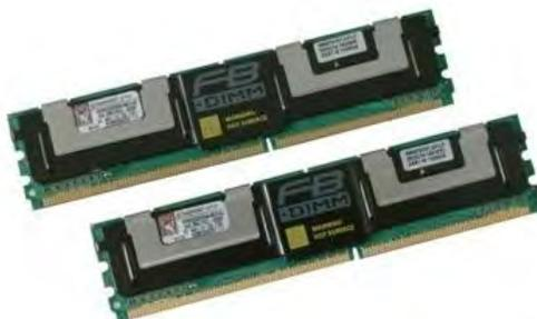
Figura 22. Ejemplo de RAM para servidor
