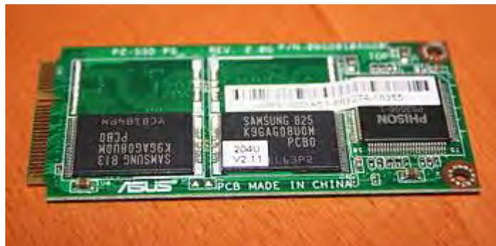
Figura 25. Tarjeta Estado Sólido (SSD) de un Asus Eee Pc 901 de 8 GB (Mini PCI Express)
