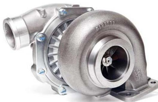
Figura 1.5: Turbocargador de doble entrada marca Garrett<sup>®</sup> GT3788R [10].
