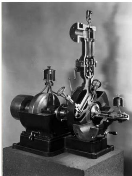
Figura 1.2: Turbina de vapor de Laval de 1888 [8].
