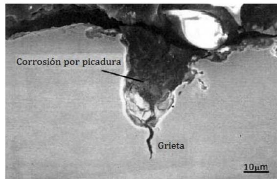
Figura 2.13: Crecimiento de grieta producto de la picadura por corrosión [32].
