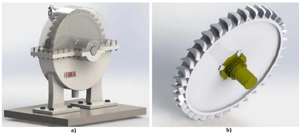
Figura 1.15: a) Ensamble de la microturbina y b) rotor de flujo axial (IIDEA) [20][21].
