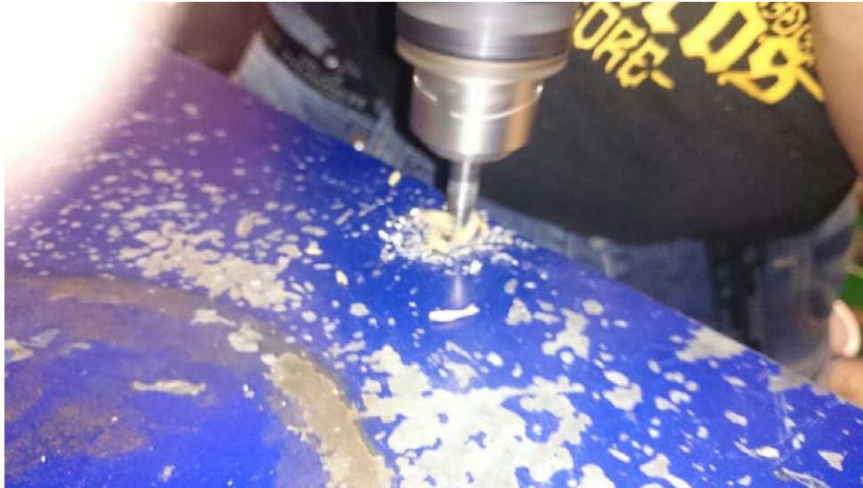
Figura 4.6.- Perforación de la mesa.
