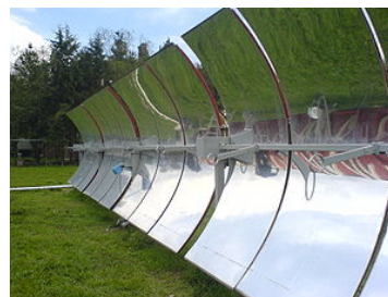
Figura 5 Sistema de canal parabólico.
