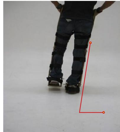
La inclinación máxima que se produce en cada paso es de  $15^\circ$  con relación a la vertical. Esto ocasiona un oscilamiento en la marcha que se considera como factor de riesgo para el piloto ya que lo correcto, en comparación a una marcha sin el simulador, es una inclinación no mayor a  $5^\circ$ .
