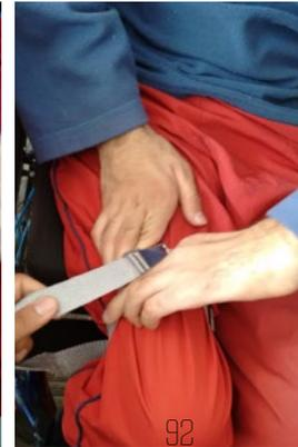
En estas pruebas se evalúa la eficiencia del sistema de sujeción considerando las dificultades de Jaime en el manejo del objeto. En este caso, se muestra una réplica de un cinturón de avión, el cual se acciona levantando la cara principal del mismo, liberando así el seguro.
