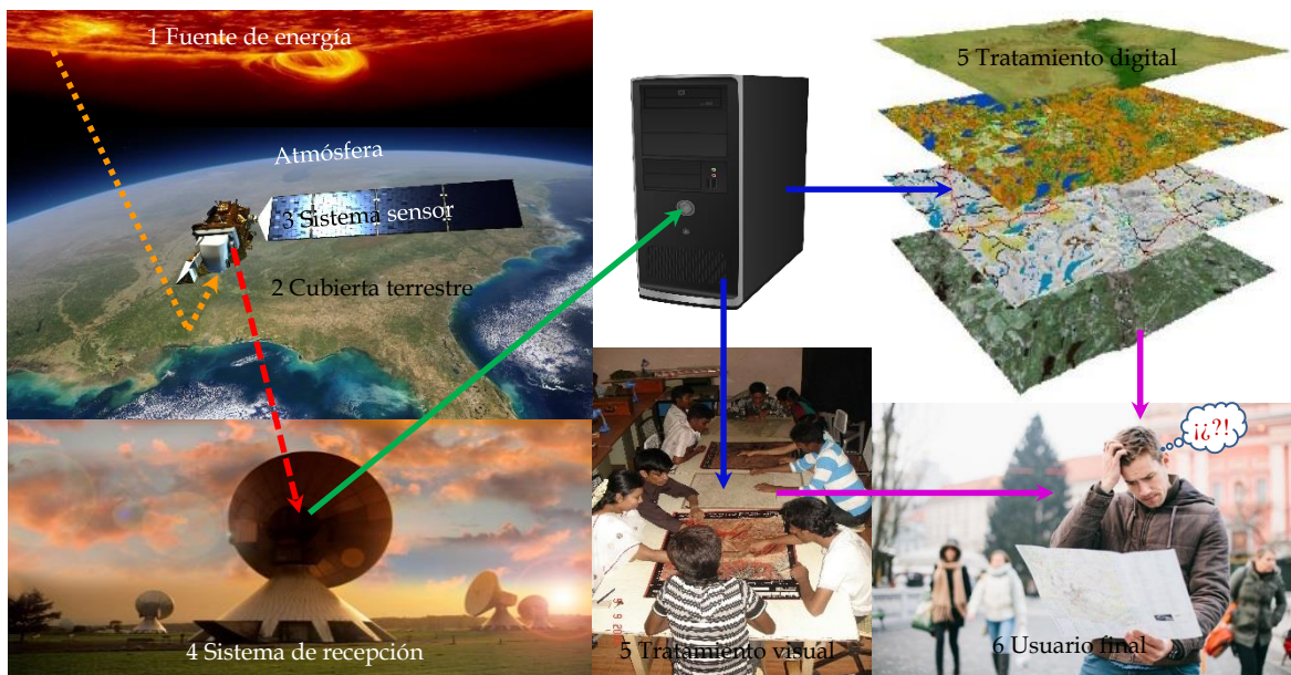
Figura 17. Componentes de un sistema de percepción remota.
