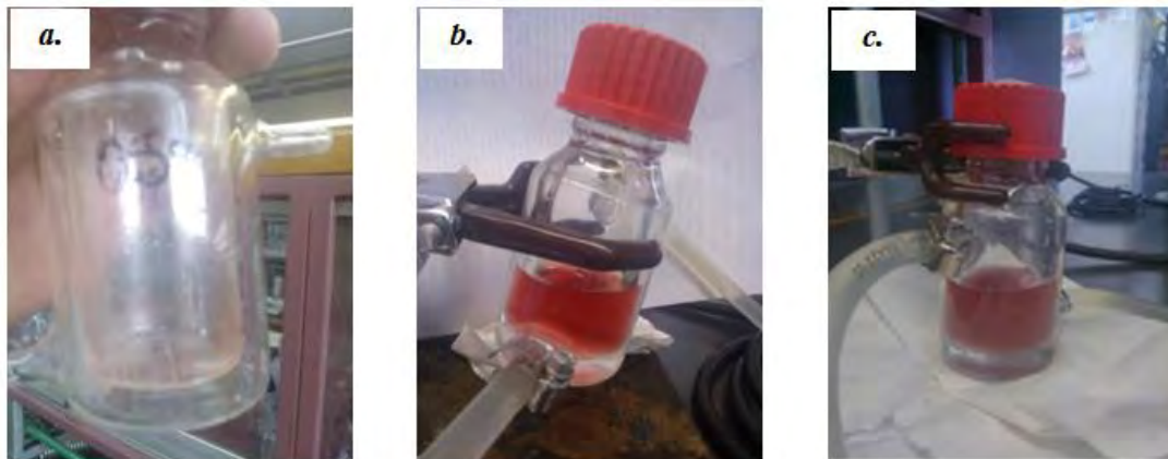
Figura 9. Polímero de Impresión Molecular por precipitación. a) Evaporación del solvente. b) 4 horas de polimerización. c) 12 horas de polimerización.
