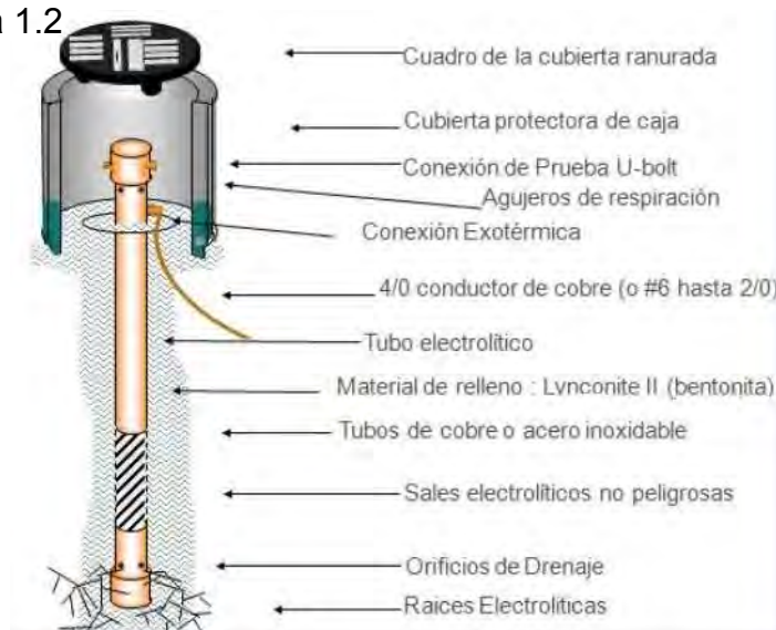
Figura 1.2 Sistema de aterramiento XPT (Tubo Recto)
