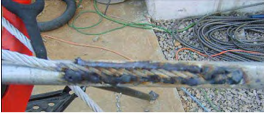
Figura 4.19 Soldadura entre cable y tubo galvanizado.
