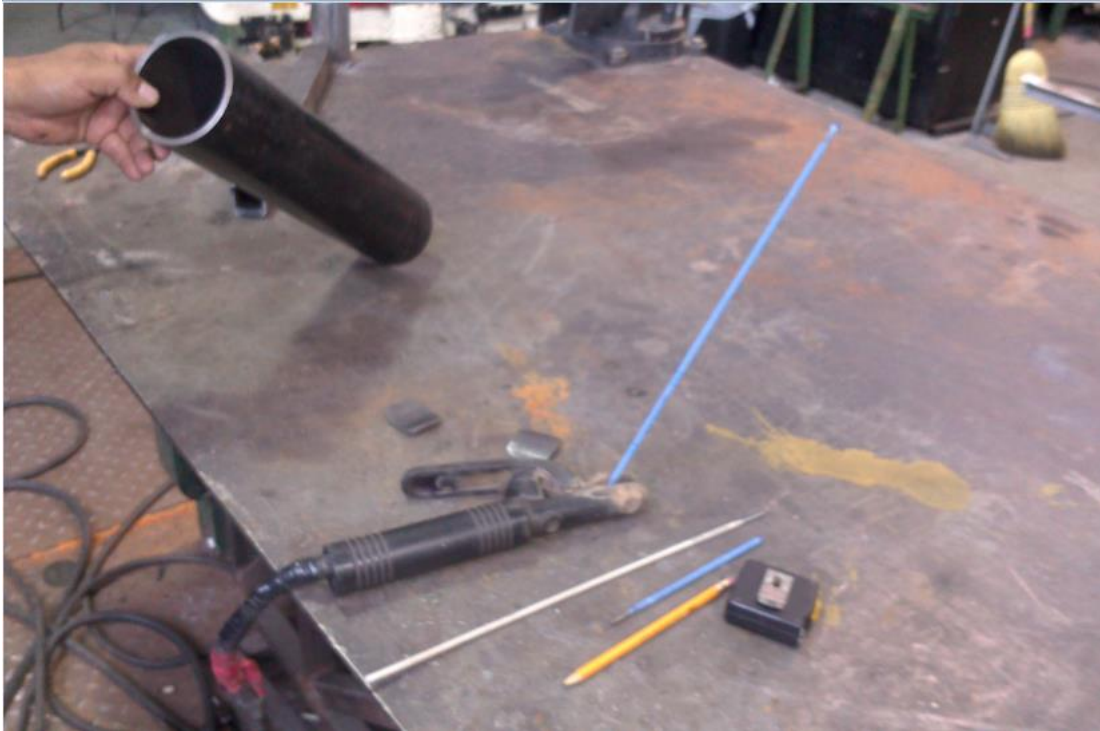
Figura 5.8. Varillas de soldadura especial para unir elementos de acero inoxidable. También se observa el diodo con el cual se soldó el mezclador.
