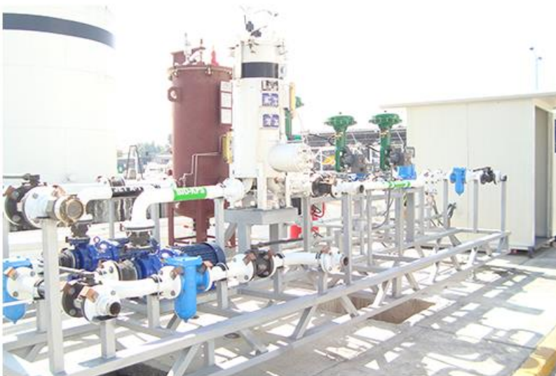
Planta de producción de bioturbosina a partir de turbosina convencional y biokeroseno vegetal desarrollada para Aeropuertos y Servicios Auxiliares.
