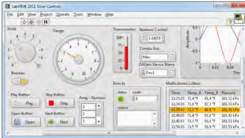
Figura 2.17 Panel de control en una aplicación estándar de LabVIEW. La interfaz de usuario se sirve de botones, perillas y demás controles gráficos o textuales operados por medio de los periféricos de la computadora para operar el instrumento virtual.
