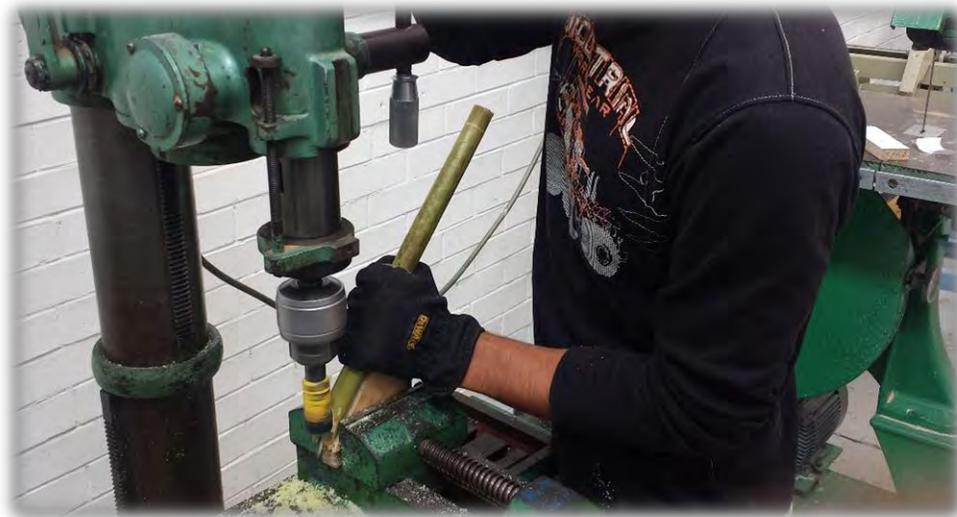
**Figura 5.5.- Corte con sacabocados.**
