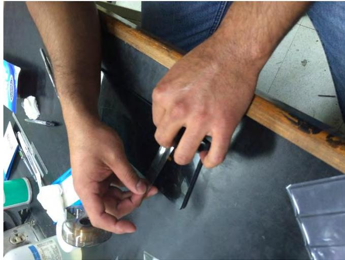
**Figura 5.14.- Cinta adhesiva colocada sobre la galga.**
