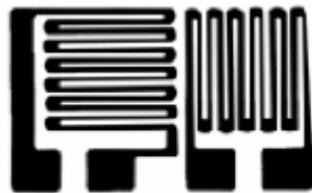
**Figura 4.10.- Arreglo de extensómetros. [31]**
