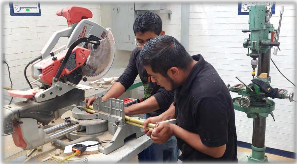
**Figura 5.3.- Corte longitudinal del carrizo.**
