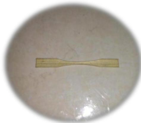
**Figura 4.6.- Muestra con marcas generadas por la prensa, debido a la presión ejercida.**
