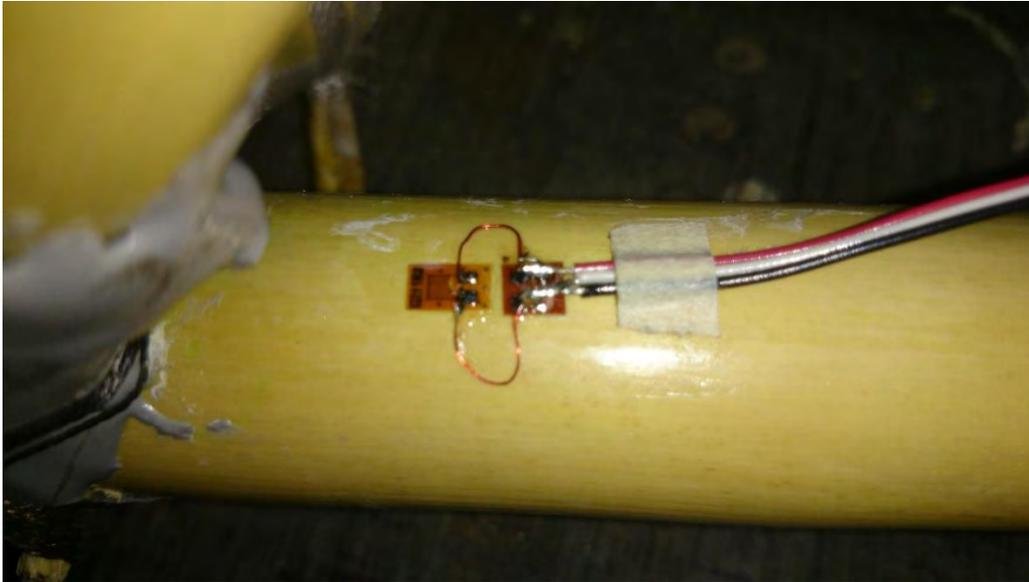
**Figura 4.3.- Extensómetro Colocado Sobre Carrizo.**
