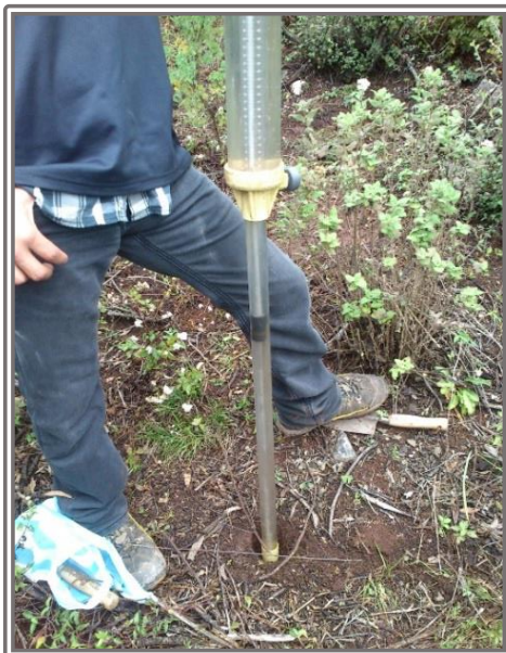
Figura 6. Evaluación de la tasa de infiltración con permeámetro Guelph.
