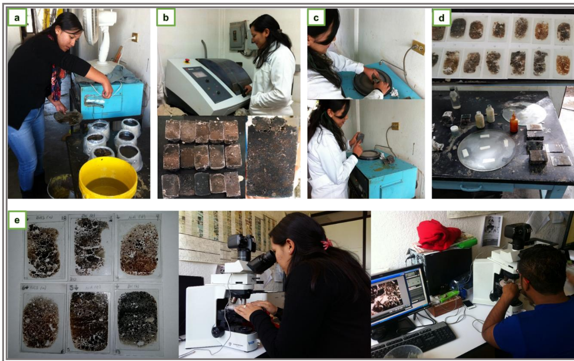
Figura 9. Preparación de secciones delgadas: a) las muestras inalteradas se impregnaran con resina b) corte de muestras con disco de punta diamante, c) pulida de muestras, d) muestras pegadas en portaobjetos y se pulen hasta tener un espesor de 30 \mu\text{m} e) análisis de fotomicrografías con Image Pro.
