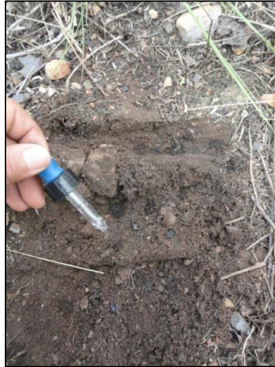
Figura 3. Evaluación de hidrofobicidad con el método WDTP en campo
